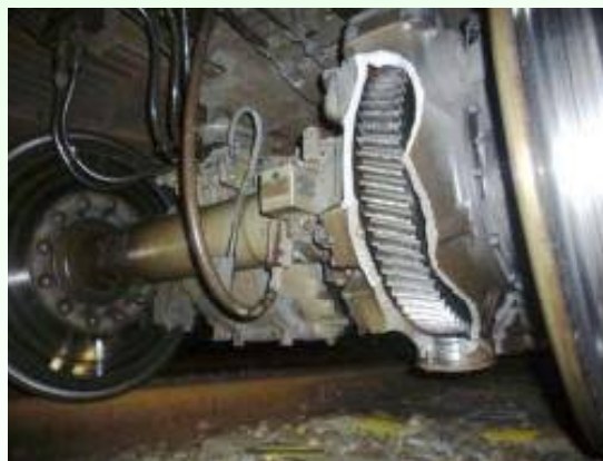
「ひかり」515号の歯車箱破損
