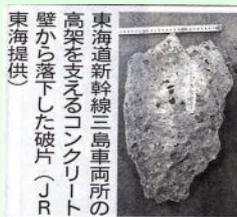
東海道新幹線三島車両所の高架を支えるコンクリート壁から落下した破片（JR東海提供）
