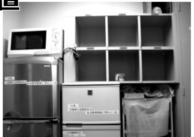
小型冷蔵庫上におかれた「個人用ロッカー(6人用)」。冷蔵庫上に重量物を身半分で設置、右下収納ボックスとの間にはすき間があり、転倒防止を右隣の大型書庫が支えている。
